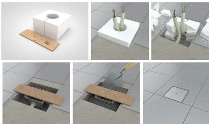
Accessoires : bloc de polystyrène + planche de nivellement
