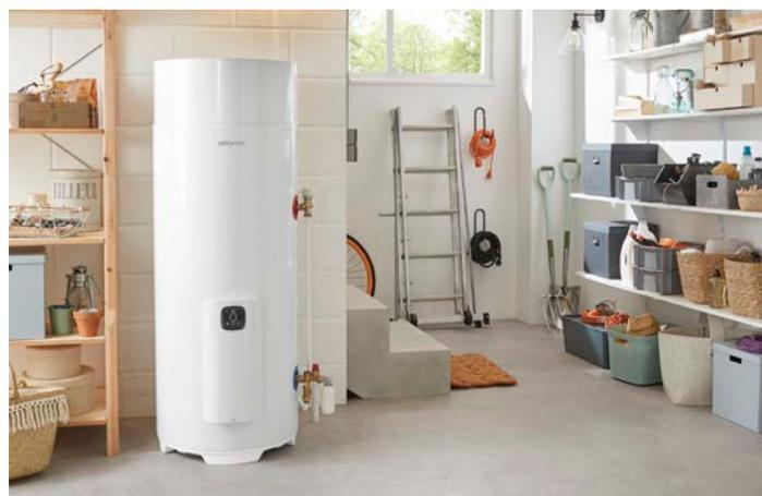
EGEO est le nouveau chauffe-eau thermodynamique connecté conçu spécialement pour la rénovation. N'ayant pas besoin d'être gainé il convient très bien en remplacement d'un chauffe-eau électrique tout en respectant les règles d'installation (pièce non-chauffée, volume > 20 m<sup>3</sup> hors encombrants, température > à 5°C).
